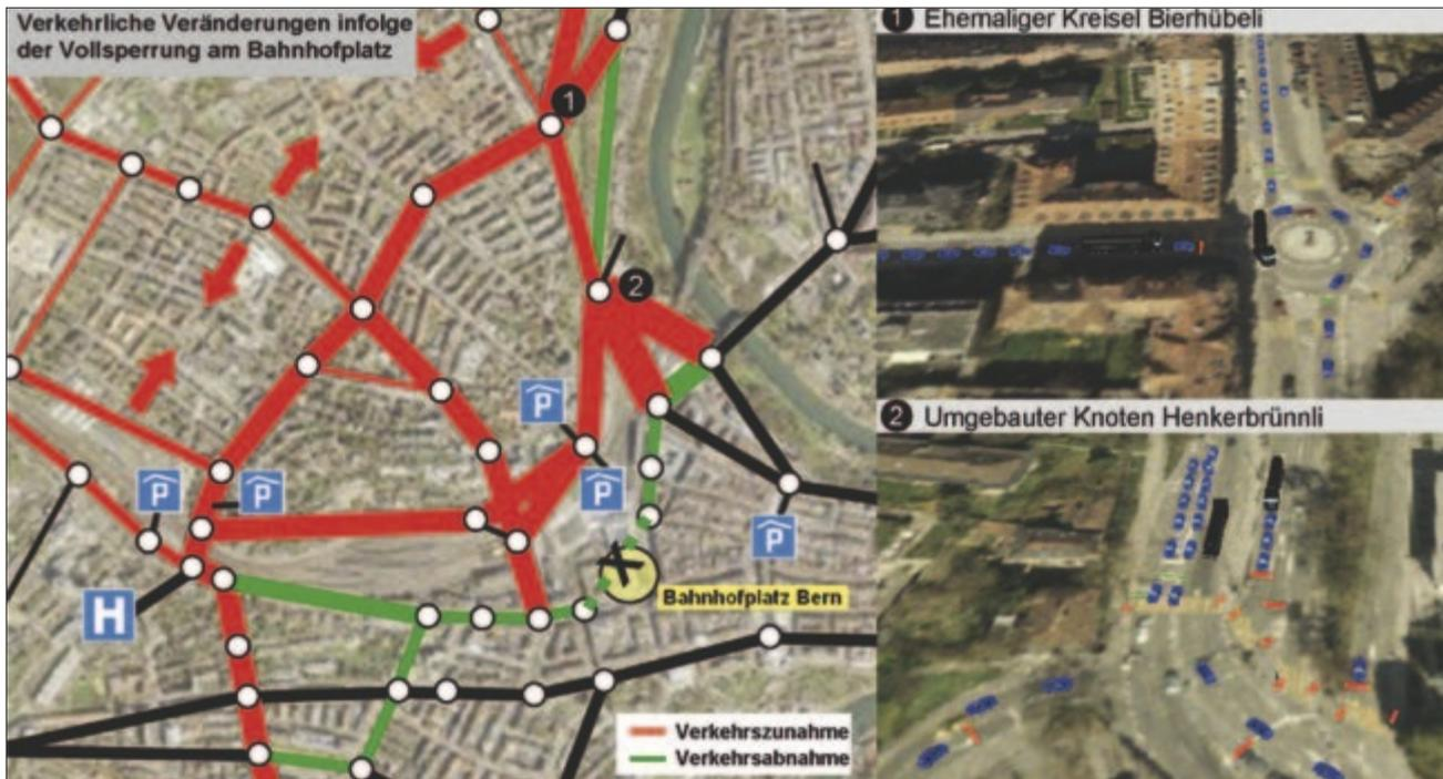
3: Verkehrliche Auswirkungen infolge der Vollsperrung am Bahnhofplatz (links: Belastungsänderungen im Stadtnetz, rechts oben: VISSIM-Simulation Bestand ohne Umbau Bierhübeli, rechts unten: VISSIM-Simulation mit Massnahmen am Knoten Henkerbrännli).
