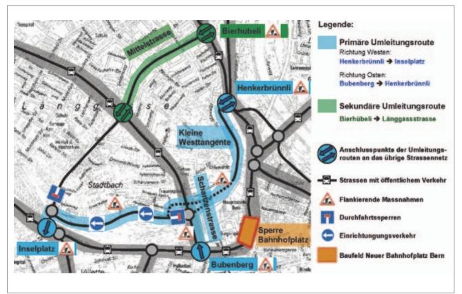
2: Das technische und verkehrliche Konzept GVK/FM mit den Umleitungsrouten.
