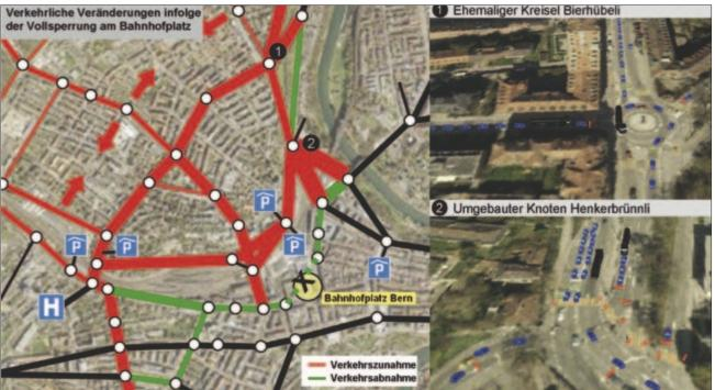
3: Verkehrliche Auswirkungen infolge der Vollsperrung am Bahnhofplatz (links: Belastungsänderungen im Stadtnetz, rechts oben: VISSIM-Simulation Bestand ohne Umbau Bierhübeli, rechts unten: VISSIM-Simulation mit Massnahmen am Knoten Henkerbrünnli).
